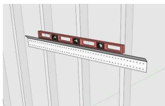
3. Utiliser un crayon et marquez la position des trous du support de la tablette sur un minimum de 3 montants. Les trous du support doivent être centrés sur les montants et ceux-ci doivent être configurés tel que l'image présentée à l'étape 4. Un montant doit être centré dans l'ouverture et deux autres montants doivent être espacés de 16" centre en centre de chaque côté du montant central.
