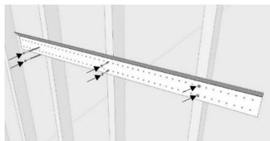
5. Avec une personne à chaque extrémité, soulevez la tablette, puis centrez le support dans la cavité à l'arrière de la tablette. Appuyez la tablette à la surface du mur et abaissez-la avec précaution sur le support. Assurez-vous que la tablette est bien en place avant de placer tout le poids de la tablette sur le support.
