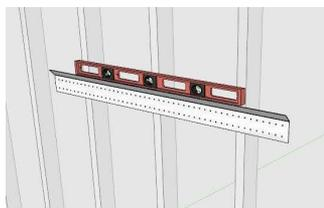
3. Utilisez un crayon pour marquer l'emplacement des trous sur le support, en l'alignant avec un minimum de 3 montants.
