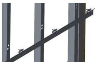
(À gauche) Boulons d'ancrage passant à travers les panneaux et montants.
