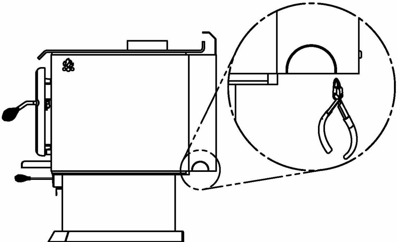
2. Installez le ventilateur entre le caisson et la tôle arrière de convection en alignant les deux trous pré-perçés du boîtier du ventilateur aux trous de la tôle arrière et fixez-le à l'aide des deux vis fournies. Les louveres devraient être en dessous du boîtier du ventilateur.
