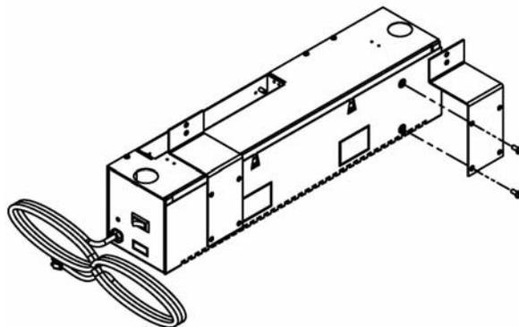
2. Installez le ventilateur sur la tôle arrière de convection en alignant les trous pré-perçés des supports du ventilateur aux trous de la tôle arrière et fixez-le à l'aide des quatre vis fournies. Les louveres devraient être en dessous du boîtier du ventilateur.
