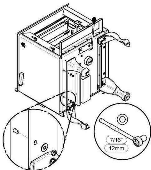
5- Installez les supports de pattes au poêle à l'aide des boulons, des rondelles et des écrous conservés à l'étape 3. Les supports peuvent être installés d'un côté comme de l'autre.
