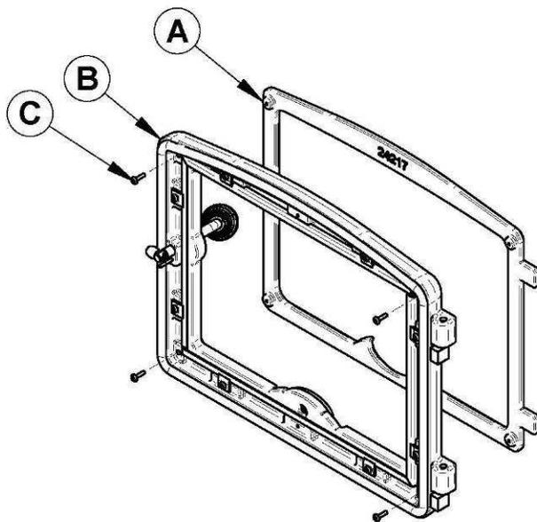
Positionnez le revêtement (A) sur la porte (B) et fixez-le en place par derrière en utilisant les 4 vis (C) fournies avec ce dernier.
