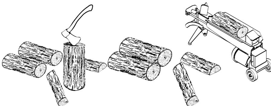
Le bois devrait être fendu de différentes grosseurs, allant de 3 po. à 6 po. (75 mm à 150 mm) d'épaisseur. Il est beaucoup plus facile d'allumer et de raviver un feu avec des bûches de différentes grosseurs. Souvent, le bois de chauffage acheté d'un fournisseur commercial n'est pas fendu assez petit pour alimenter un feu. Il est parfois préférable de refendre le bois avant de le corder pour qu'il sèche.
