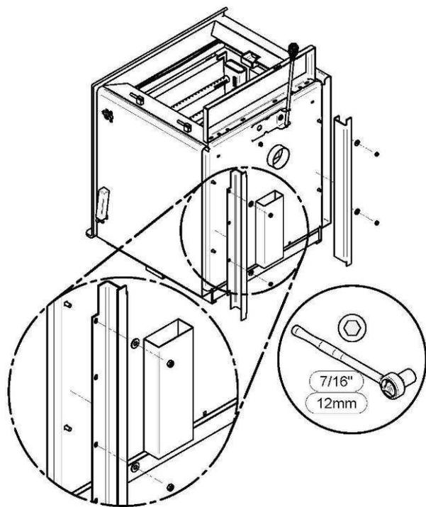
3- Dévissez les 4 écrous pour enlever les 2 supports d'acier. Disposez des 2 supports d'acier car ils ne sont plus nécessaires. Conservez les boulons, les rondelles et les écrous puisqu'ils seront nécessaires à l'étape 5.
