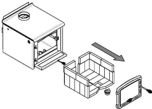
1- Retirez les briques, le bouchon à cendre et la porte de l'appareil pour éviter d'endommager des pièces et faciliter les manipulations dans les étapes suivantes.
