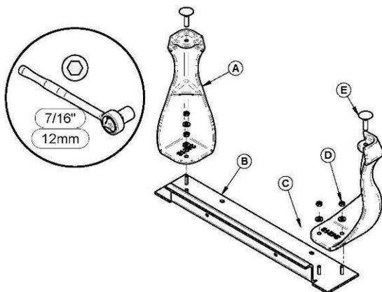
4- Installez chaque patte (A) sur le support (B) à l'aide de 2 rondelles (C) et 2 écrous (D) fournis avec le kit. Répétez la procédure d'installation pour le deuxième support de pattes.
