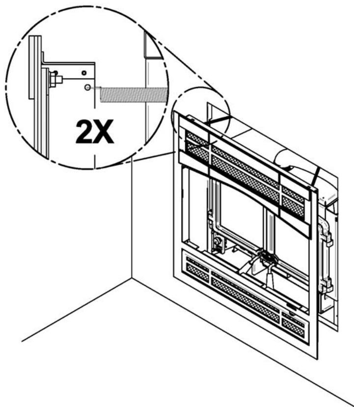
2. Appuyez la façade sur le foyer et fixez le bas de celle-ci à l'aide de 2 vis auto-perforantes fournies dans l'ensemble de manuel du foyer.
