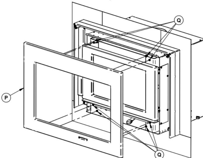
Finalisez le positionnement du poêle à bois encastrable afin que les panneaux de finition intermédiaire de façade s'appuient contre le revêtement avant du foyer puis référez-vous aux instructions du manuel fourni avec votre appareil de chauffage pour l'installation de l'ensemble de façade en fonte (P) à l'aide des vis (Q) déjà installées sur le devant du caisson de l'encastrable.
