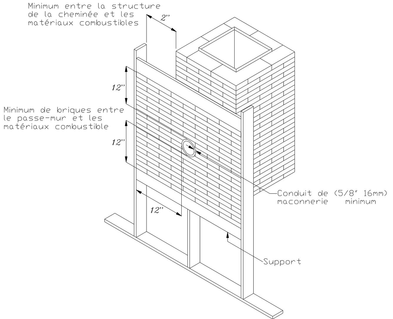
**FIGURE 2.2.2 (C) Passe-mur de briques**
