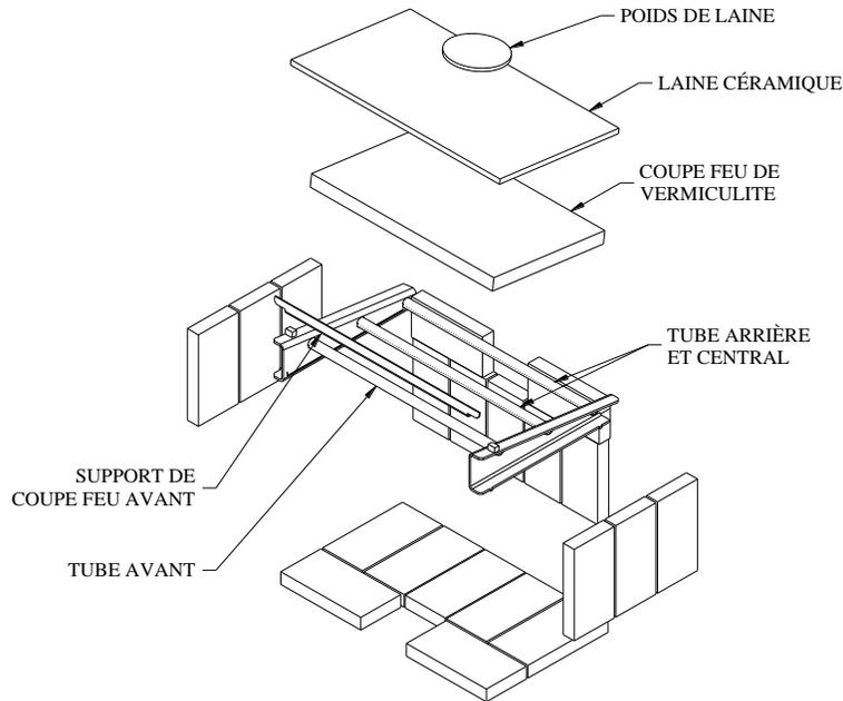
**Figure 4.6.3 (A) - Installation du coupe-feu pour le modèle Osburn 2000**
