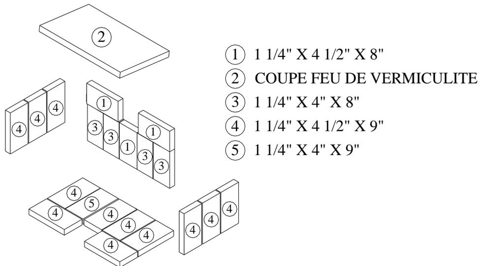
**Figure 4.6.3 (B) - Disposition des briques pour le modèle Osburn 2000**
