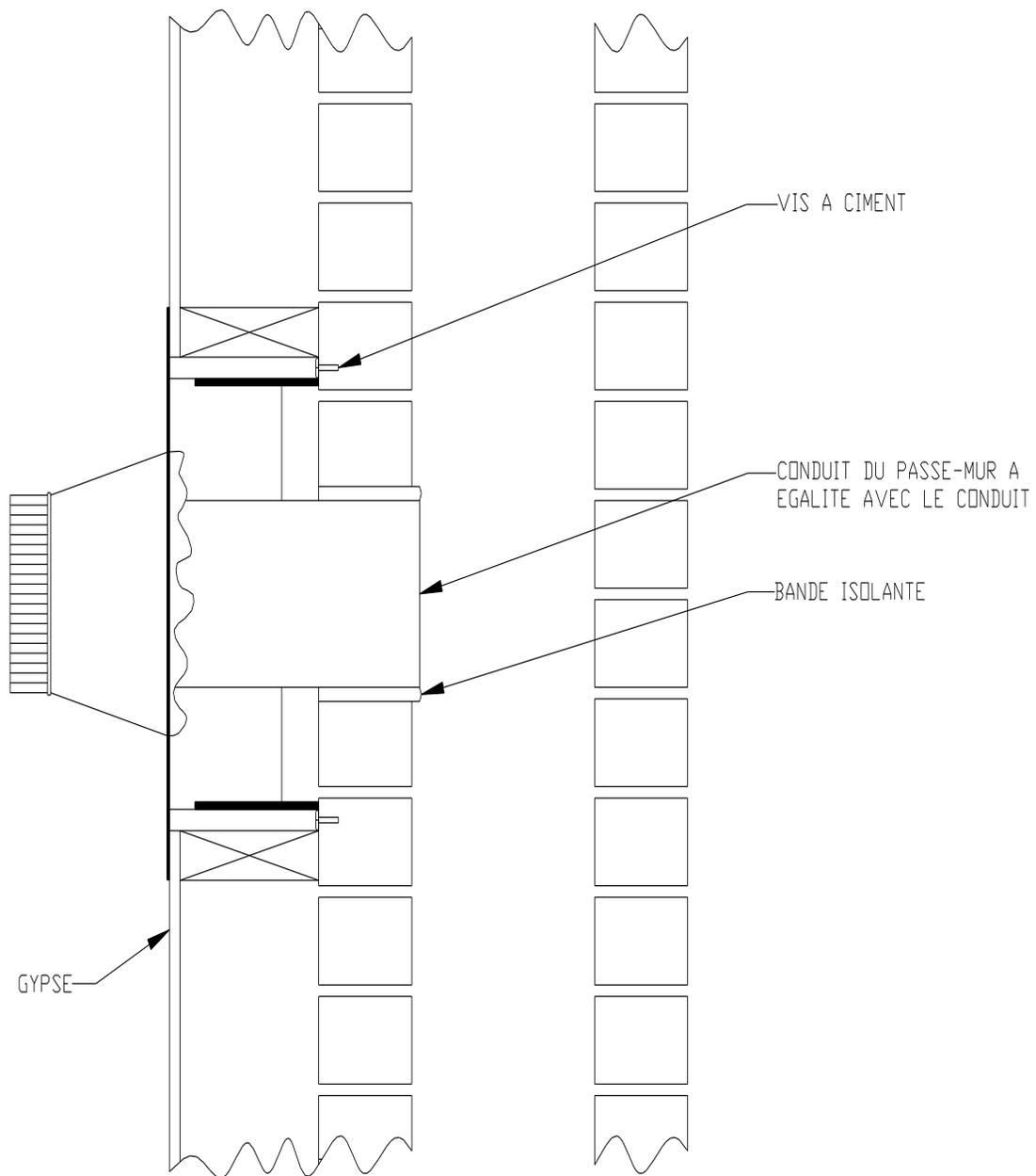
**FIGURE 2.2.2 (B) Passe-mur préfabriqué**
