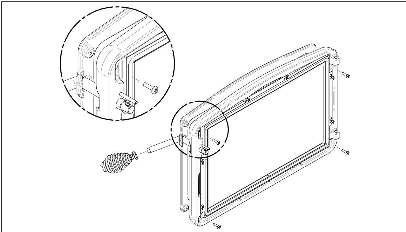
1- Positionnez le revêtement sur la porte et fixez-le en place par-derrière en utilisant les 4 vis.
