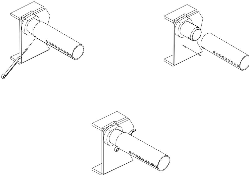
**Figure 4.3 – Remplacement des tubes d'aération auxiliaires**
