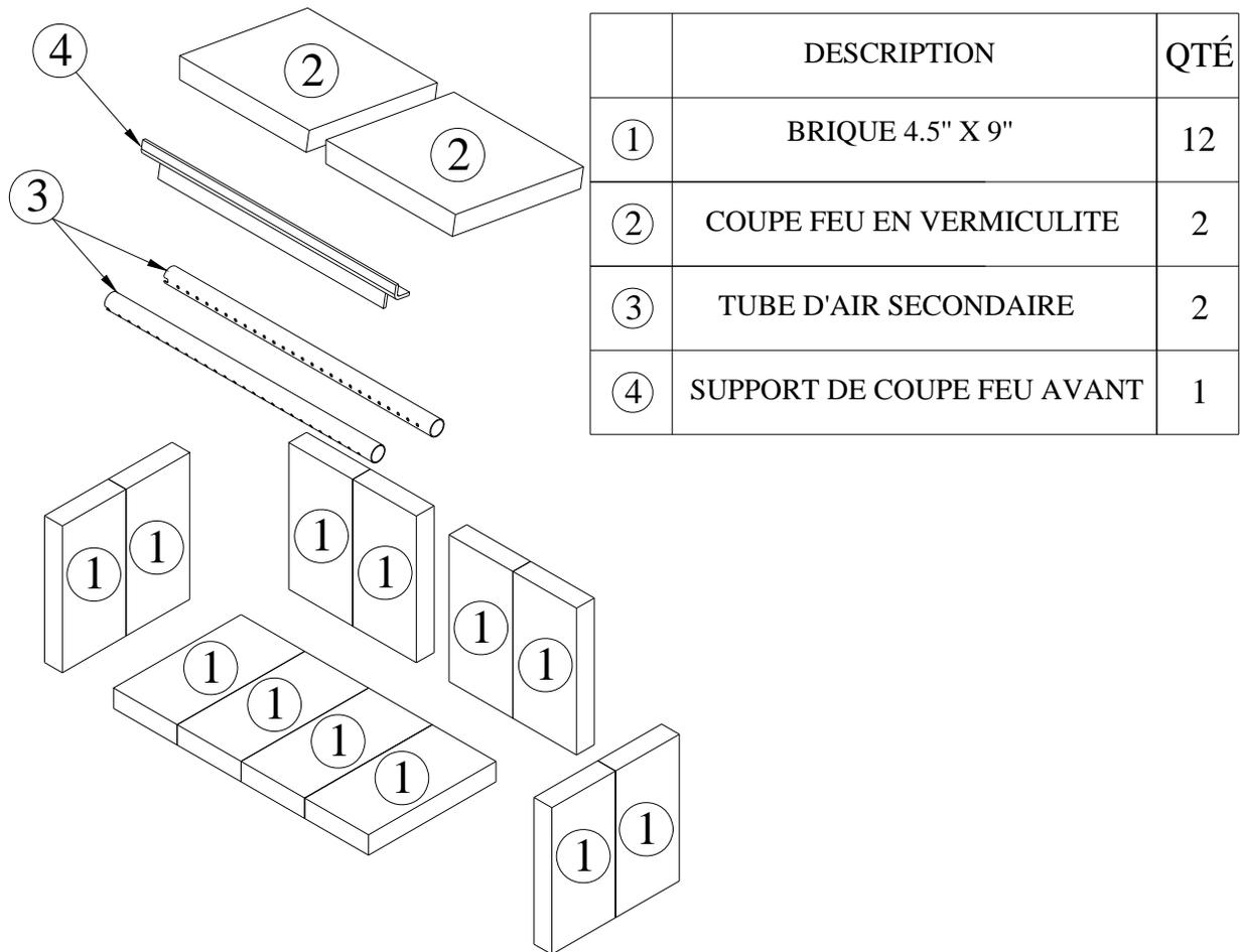
**Figure 4.2 – Disposition des briques pour l'encastable Osburn 1100**
